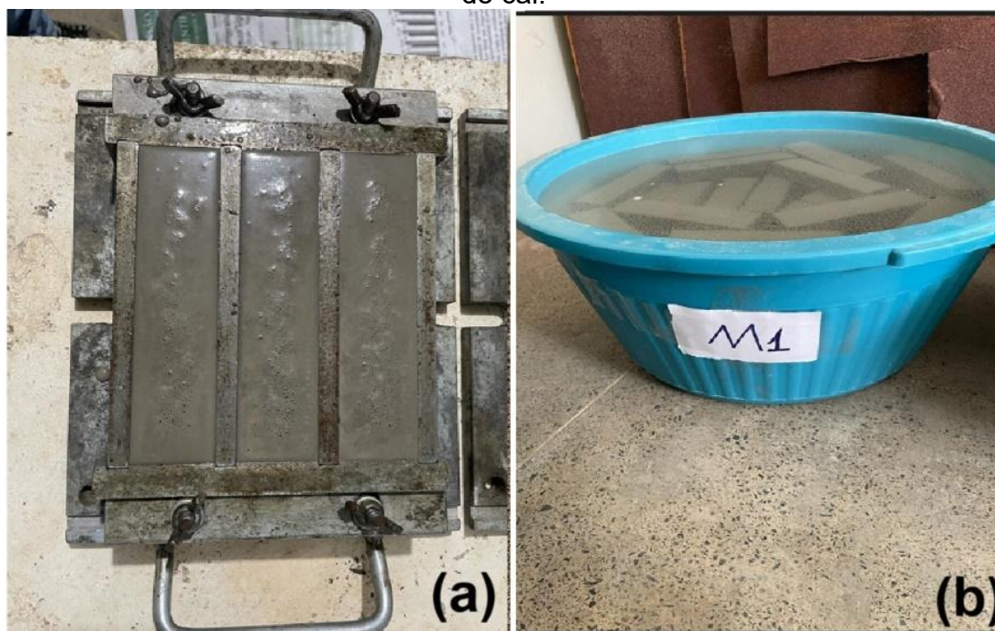
Figura 16 - (a) misturas nos moldes metálicos após processo final de moldagem e vibração; (b) corpos de prova em processo de cura em água saturada de cal.
