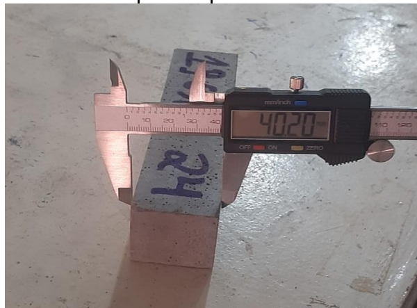
Figura 9 - Momento da medição do lado da seção transversal de um dos corpos de prova.
