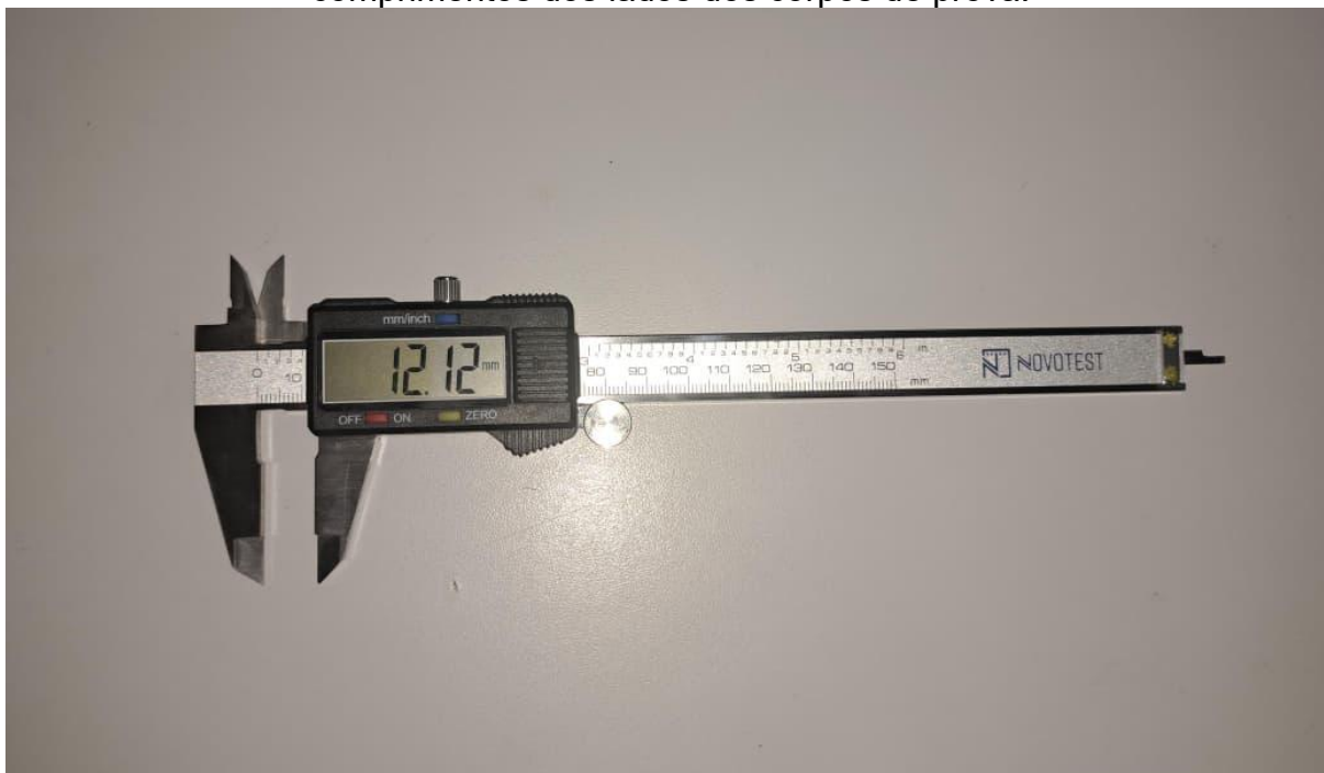
Figura 7 - Paquímetro com visor digital utilizado nas medições dos comprimentos dos lados dos corpos de prova.
