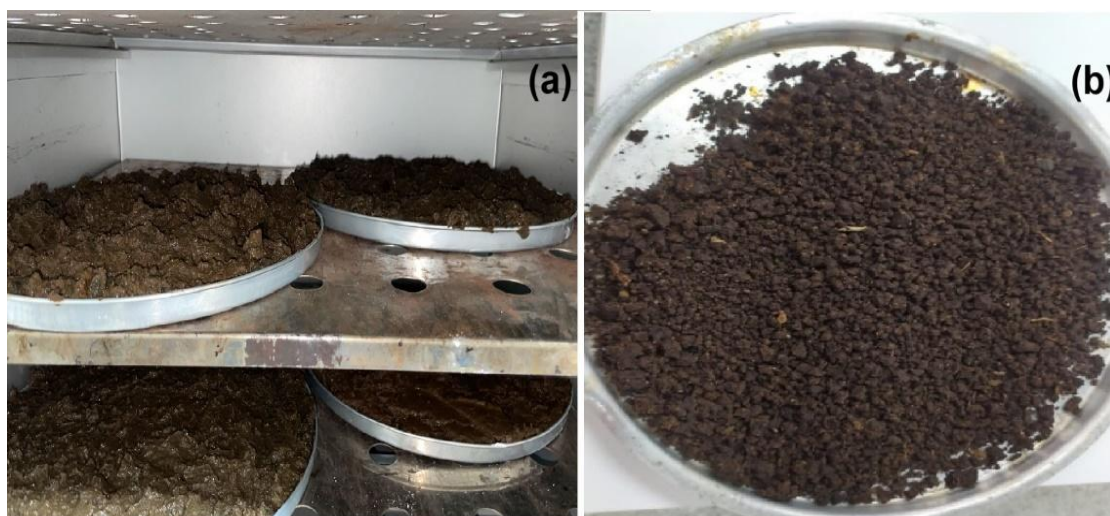
Figura 11 - (a) lodo bruto na estufa elétrica antes da secagem; (b) lodo bruto após a secagem.
