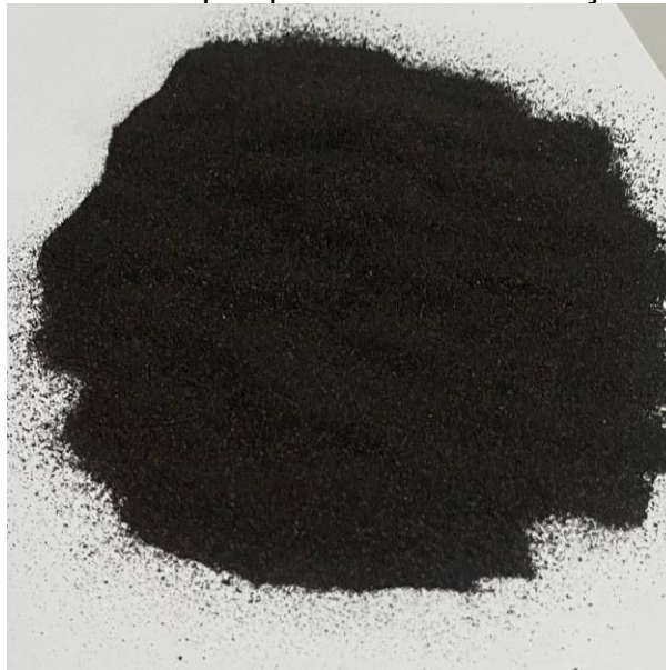
Figura 14 - Lodo de ETA após processo de calcinação em forno mufla.
