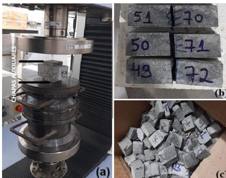
Figura 6 - (a) corpo de prova em posição para o início do ensaio de compressão; (b) corpos de prova antes do início do ensaio de compressão; (c) corpos de prova rompidos e descartados em caixas de papelão.
