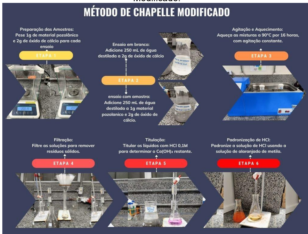
Figura 2 - Etapas necessárias para a realização do ensaio de Chapelle Modificado.
