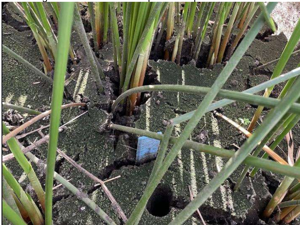
Figura 14 - Régua inserida no sistema para acompanhamento da altura de lodo
