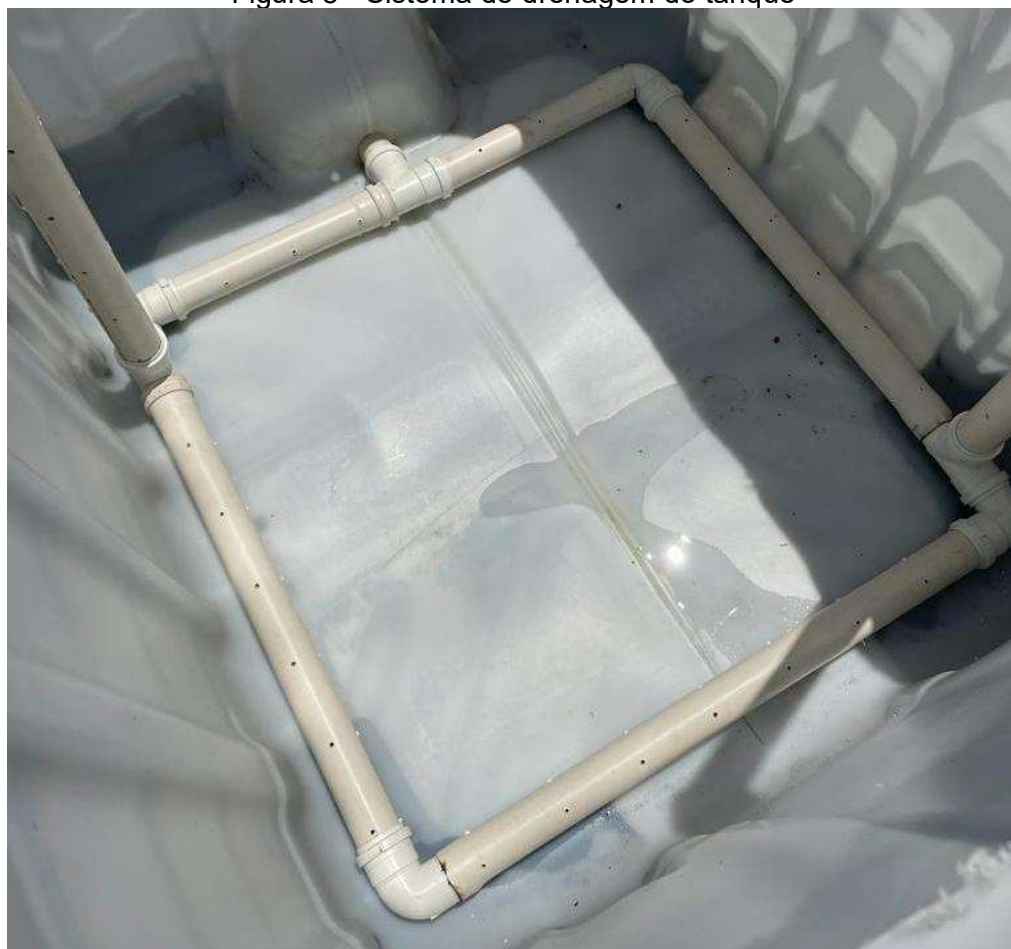
Figura 8 - Sistema de drenagem do tanque
