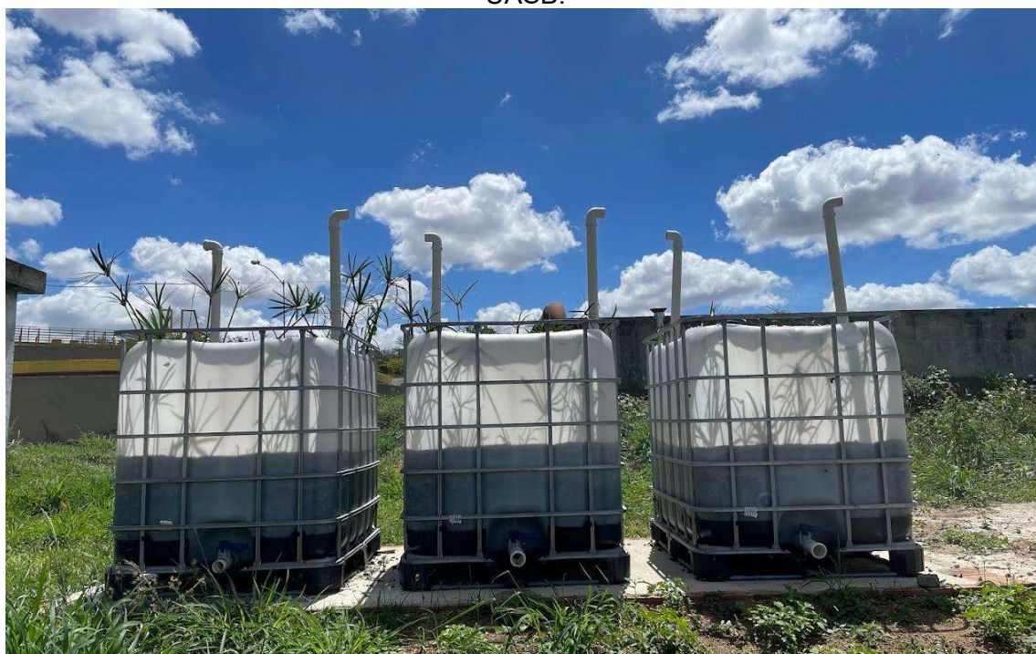
Figura 7 – Unidades experimentais de LP para tratamento de lodo proveniente do reator UASB.
