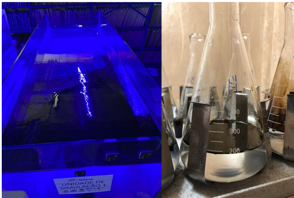
Figura 27 - Comparação do comportamento do óleo nas diferentes escalas de teste de sorção. À esquerda, unidade de simulação em mesoescala. À direita, ensaios em microescala realizados em frascos Erlenmeyer.
