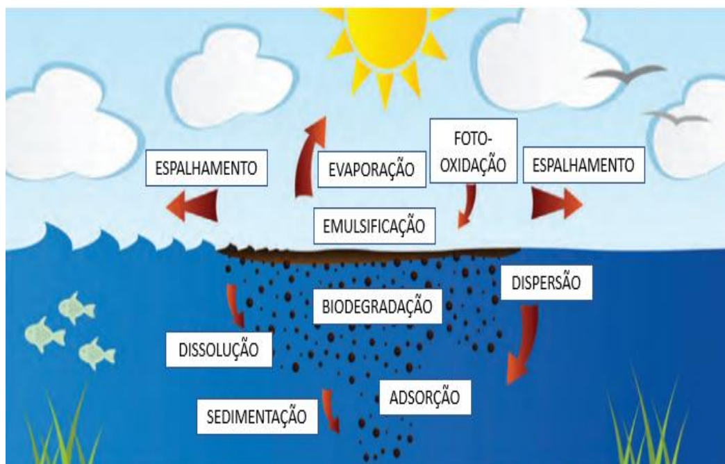
Figura 1 - Representação esquemática dos principais processos de intemperismo que afetam o petróleo em ambientes marinhos: evaporação, fotooxidação, emulsificação, dispersão, dissolução, biodegradação e sedimentação. Fonte: ITOPF (2011) (Adaptado).
