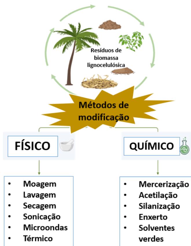
Figura 4. Ilustração esquemática das principais abordagens de modificação aplicadas à biomassa lignocelulósica residual. Os métodos são categorizados em modificações físicas e modificações químicas. Fonte: Própria autora, 2025.
