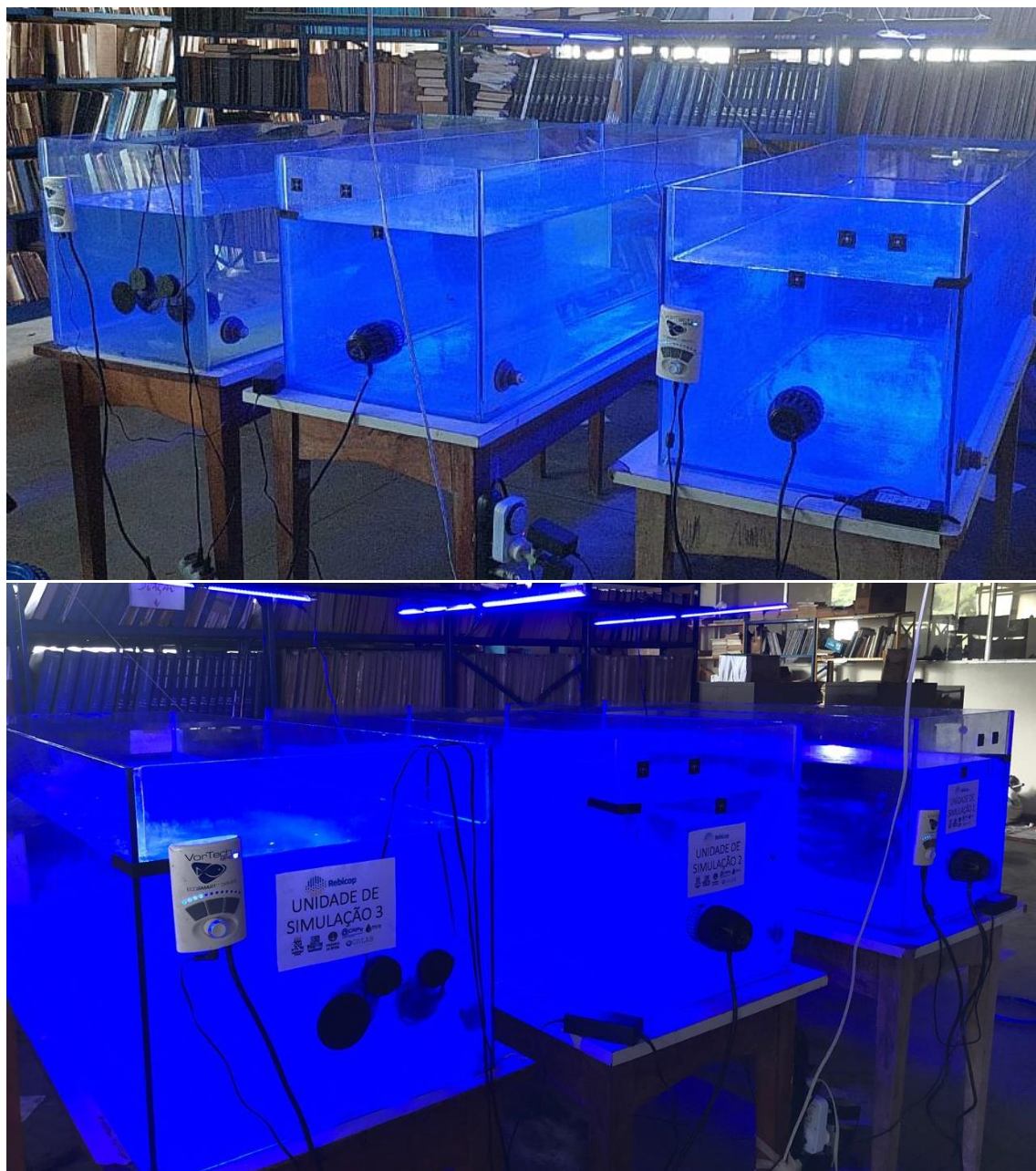
Figura 8. Mesocosmos laboratoriais utilizados para simular o intemperismo de petróleo em condições marinhas controladas, com agitação e iluminação artificial.
