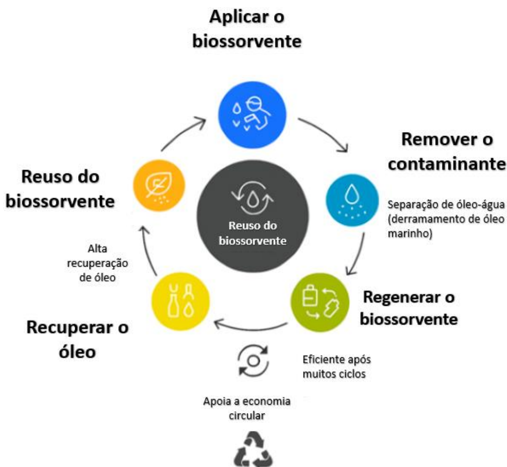
Figura 5. Representação esquemática do ciclo de reutilização de sorventes de base biológica na remediação de derramamentos de óleo no mar. O ciclo ilustra a abordagem dos "4 Rs": Remover, Regenerar, Recuperar e Reutilizar. Fonte: Própria autora, 2025.
