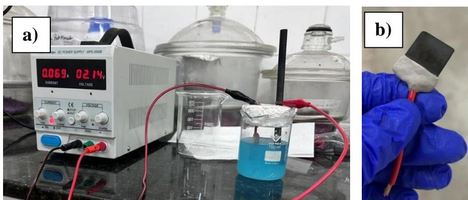
Figura 11 - Representação esquemática da célula de eletrodeposição (a) e aspecto final do revestimento (b).
