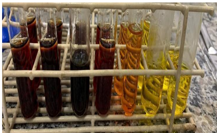
Figura 46. Variação colorimétrica da reação do ácido DNS com diferentes concentrações de glicose para elaboração da curva padrão.
