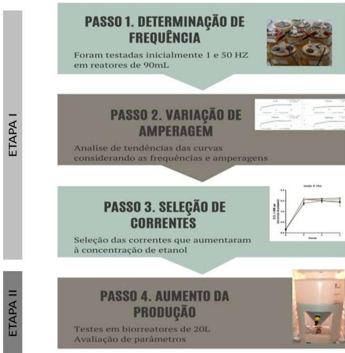
**Figura 2:** Fluxograma com etapas do estudo. Etapas I) Passo I: testes de correntes em biorreatores de 90mL; Passos II: avaliação de tendência das curvas; Passo III: Seleção da corrente; Etapa II) Passo IV: testes usando a melhor corrente em 20L.
