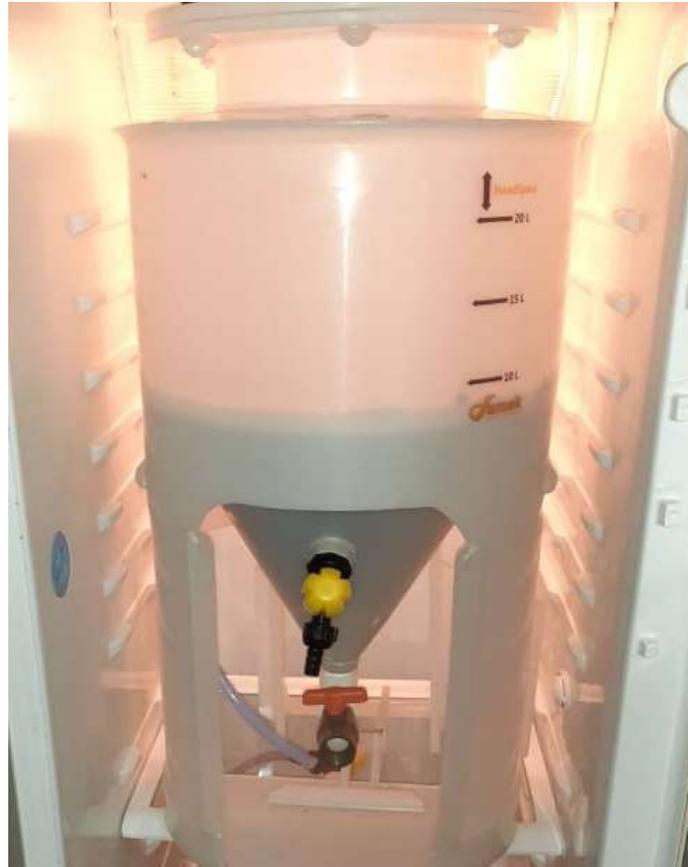
**Figura 4:** Biorreator de polipropileno modificado.
