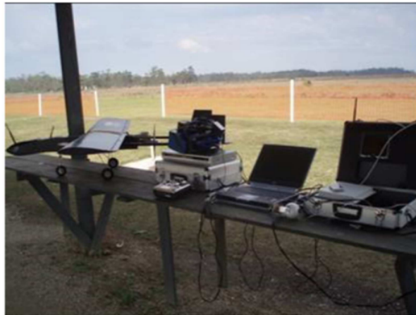
Figura 13 – VANT de inspeção juntamente com estação de controle, [RANGEL; KIENITZ; BRANDÃO, 2009].
