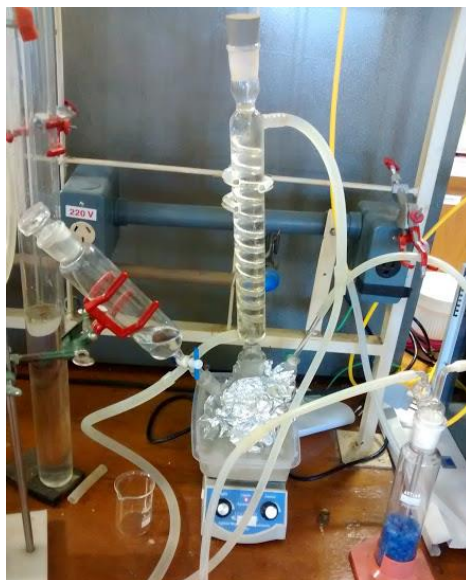
Figura 11. Sistema reacional dos líquidos iônicos sintetizados nesse trabalho
