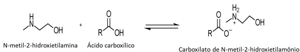
Figura 18. Esquema da reação dos líquidos iônicos da série do [m-2HEA + ].
