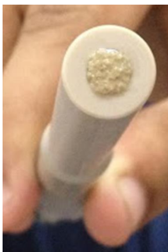
Figura 58. Ilustração do eletrodo oco preenchido com material catalítico CAT-I.
