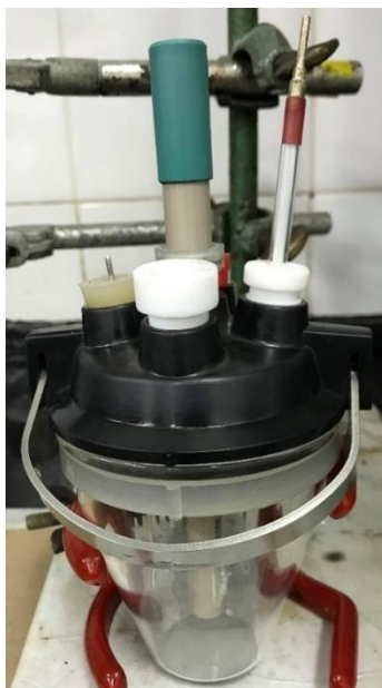
Figura 15. Sistema eletroquímico usado na caracterização dos bioeletrodos CLEA. Eletrodo de trabalho (material catalítico introduzido no eletrodo oco), eletrodo de referência (fio de prata) e contra eletrodo (placa de platina).
