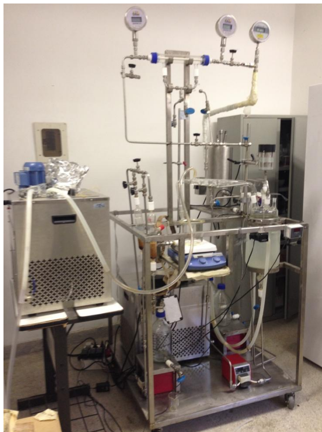
Figura 13 - Sistema reacional para a produção de biodiesel
