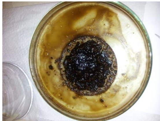
Figura 4.10: Cera precipitada dissolvida em n-hexano
