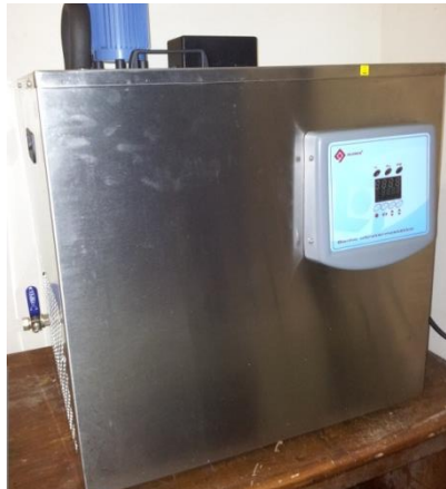
Figura 4.8- Banho Termostático 1 utilizado na precipitação da cera
