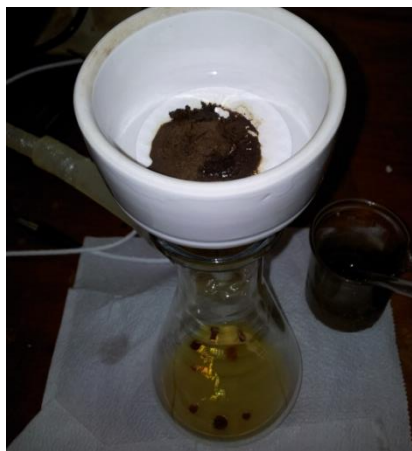
Figura 4.9: Filtração a vácuo com funil de buchner
