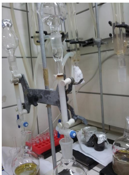
Figura 4.5- Cromatografia líquida em coluna aberta realizada
