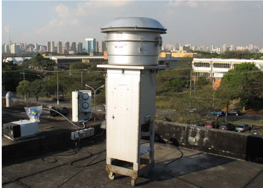
Figura 20. Amostrador tipo MP 10 instalado em sítio na Cidade Universitária da USP.
