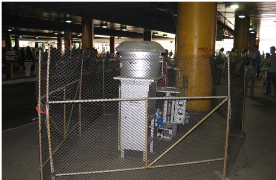
Figura 16. Amostrador modelo AGV MP 10 instalado em sítio na Estação da Lapa.
