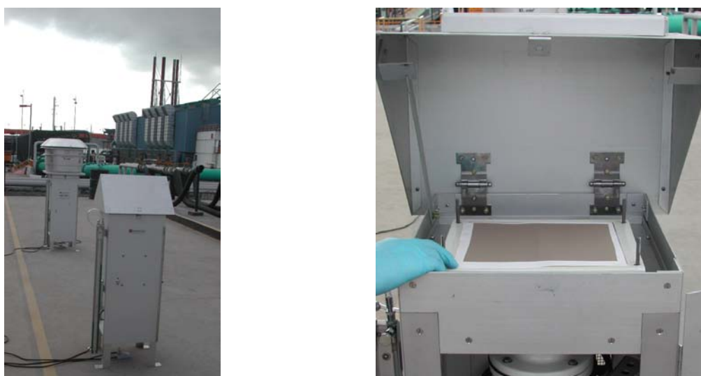
Figura 17. Amostradores tipo PTS e MP 10 instalados em Porto de Aratu. No destaque, filtro do PTS após coleta de 24 horas.
