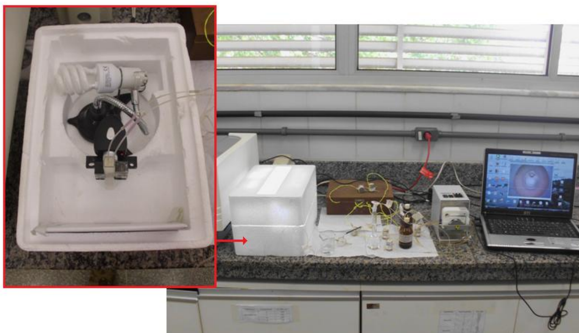
Figura 10 - Fotografia do sistema em fluxo utilizado na determinação de nitrito e nitrato.
