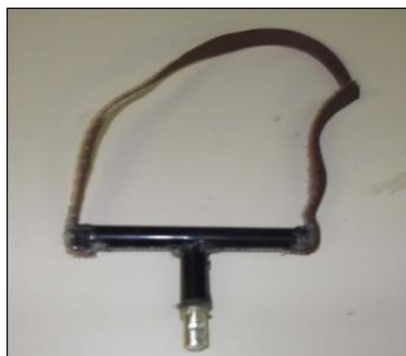
Imagem 37 – Ponteira feita de lápis piloto, haste para digitar com lápis e borracha na ponta, e velcro para prender na mão
