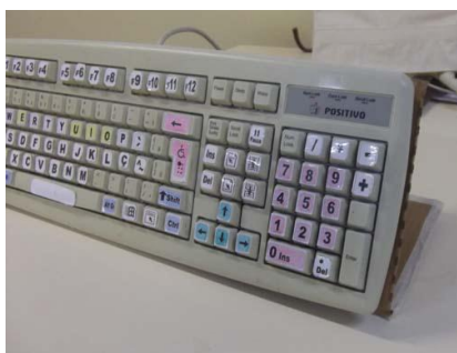
Imagem 29 – Suporte inclinado de papelão com +/- 75 graus de inclinação e teclado com letras ampliadas e cores diferentes
