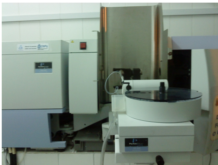
Figura 8: Espectrofotômetro de absorção atômica em forno de grafite, GFAAS. (Foto: L.F.P. Santos. 26, Jan. 2011, 18:13h – Laboratório de Química Analítica, Universidade Estadual do Sudoeste da Bahia, UESB)
