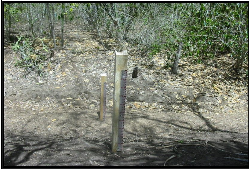
Figura 18: Posição das réguas linimétricas – calha do rio a montante do açude São Domingos
