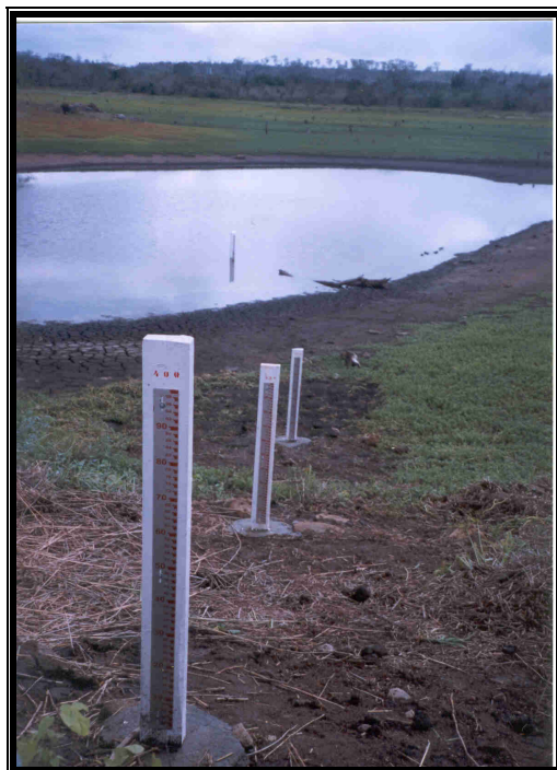
Figura 16: Régua linimétrica – açude de Nenenzinho – novembro 2003
