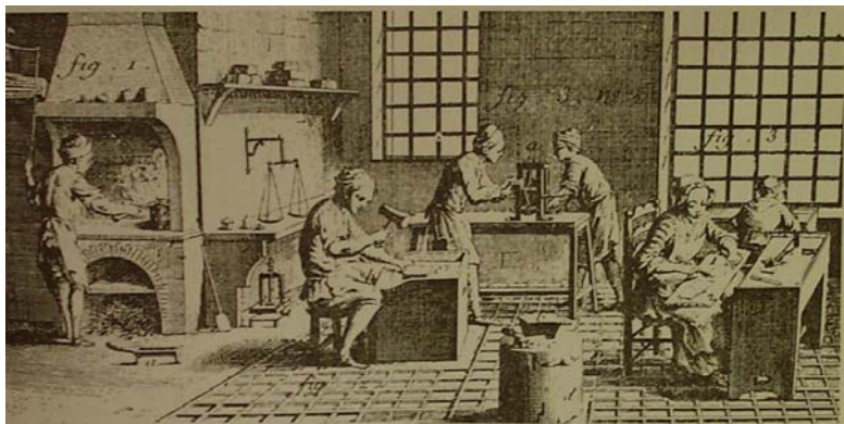
Figura 27 – Gravura francesa do século XVIII mostrando as diferentes etapas para a confecção das folhas de ouro.
