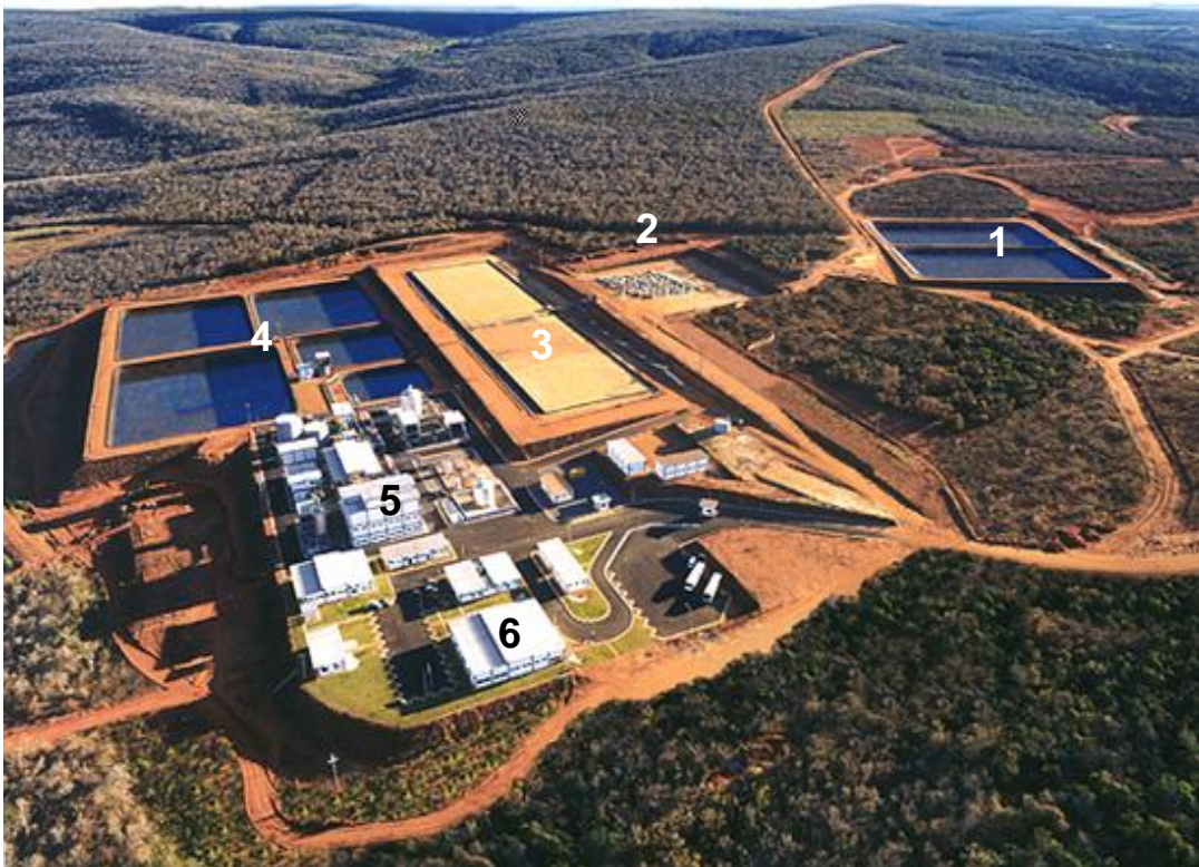
Figura 10: Vista aérea da usina de beneficiamento de urânio em Caetité, onde é possível visualizar: 1 – piscinas de armazenamento de efluentes; 2 – pátio de britagem; 3 – pátios de lixiviação; 4 – piscinas de armazenamento de licor; 5 – unidade de processamento de urânio; e 6 – área administrativa.
