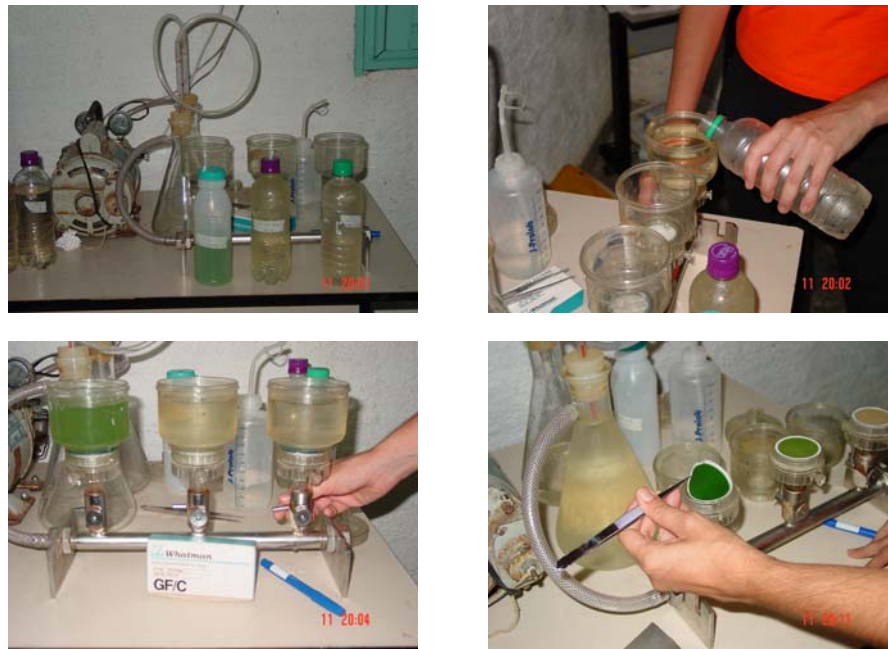
Figura 5- Laboratório estruturado em campo para filtragem das amostras de clorofila.
