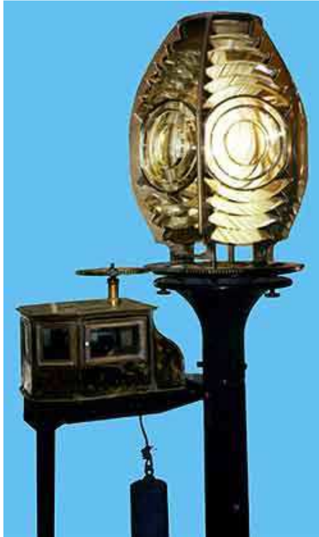
Fotografia 8: Lente Fresnel de um farol sinalizador marítimo.
