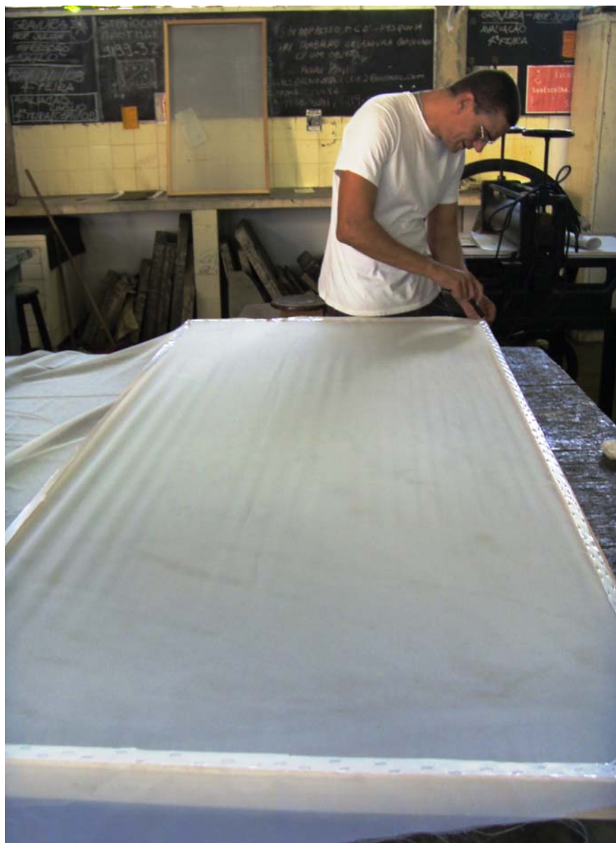
Figura 93. Confecção da tela de serigrafia em grande formato.
