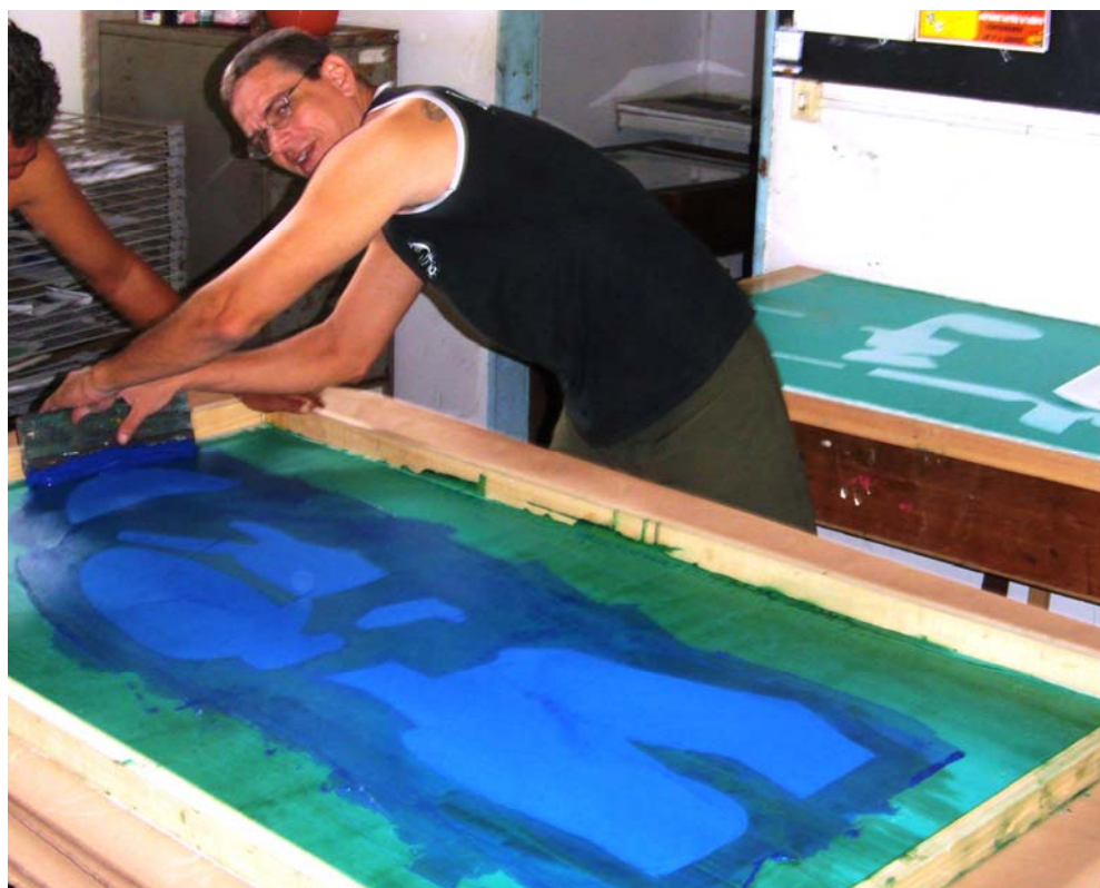
Figura 95. Imprimindo sobre papel Kraft a cor azul.
