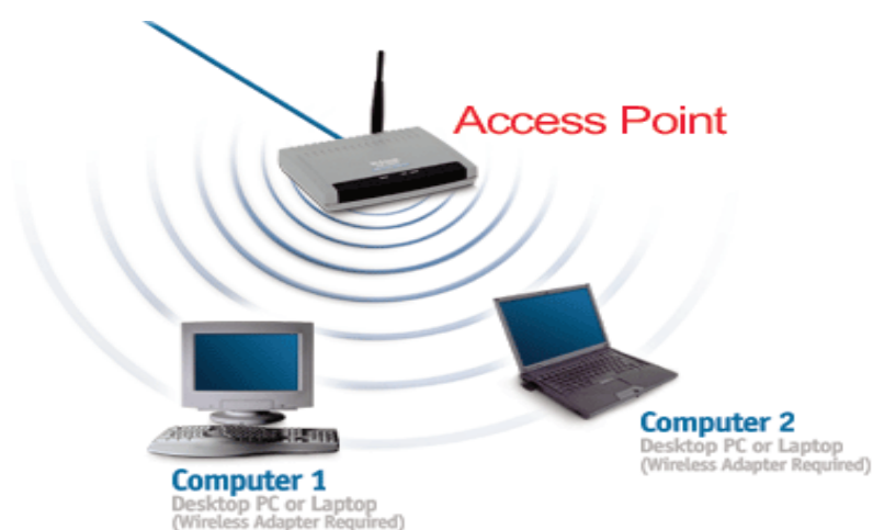
Figura 5.0 – Ponto de Acesso AP, integrando redes wireless
