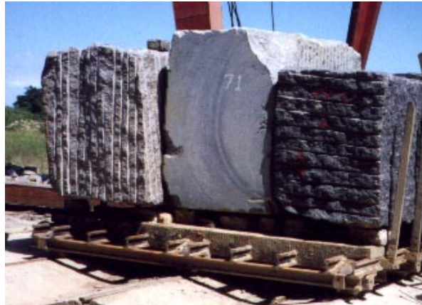
FIGURA 3: Blocos de granito sendo conduzidos para serragem no tear (Granitos Venécia – Teixeira de Freitas-BA, fotografados pela autora em 29/01/02)
