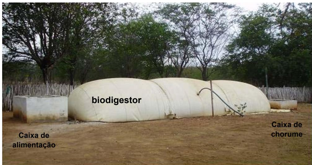
Figura 14-Biodigestor da Estação Experimental da EBDA, Jaguarari, (BA), 2009.
