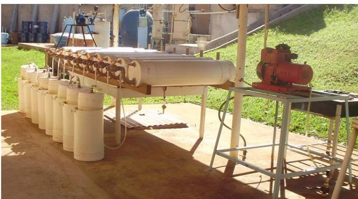
Figura 41 - Biodigestores experimentais. Motor movido a biogás. UNESP, Jaboticabal, 2009.
