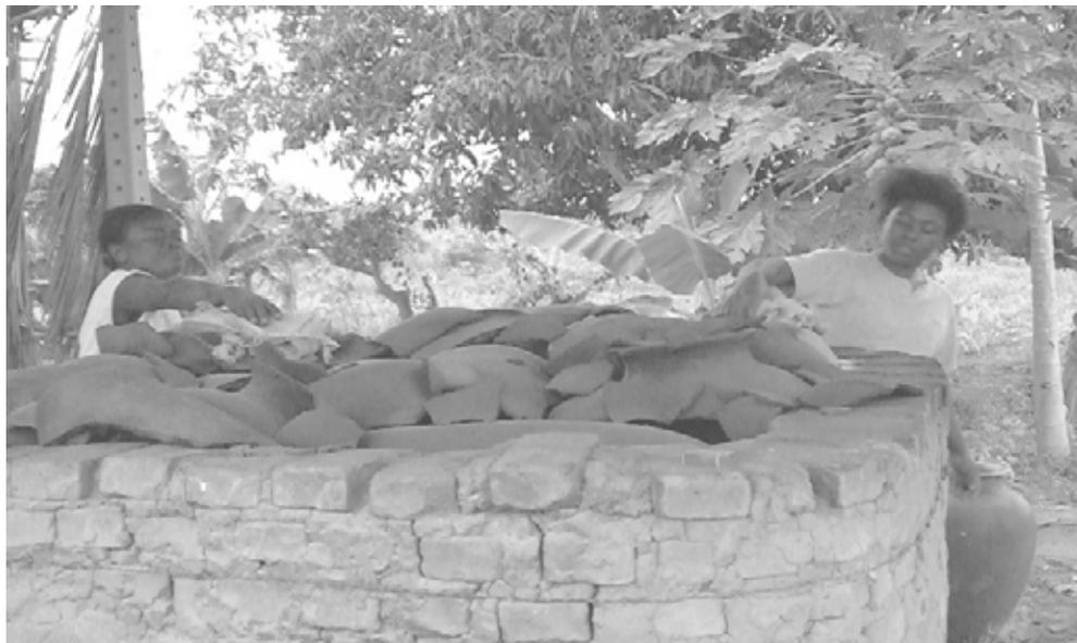
**Figura 90:** Processo da queima das peças de cerâmica.
