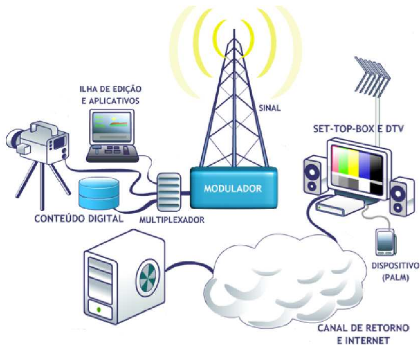
Figura 3.7. Arquitetura Básica de TV Digital [2]
