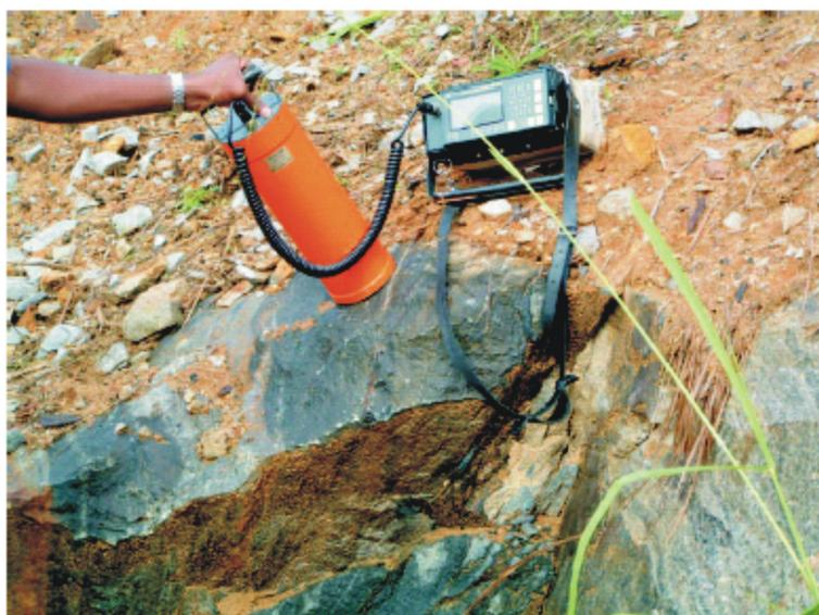
Figura 3.3: Medidas em campo usando o espectrômetro gama portátil GS-512.
