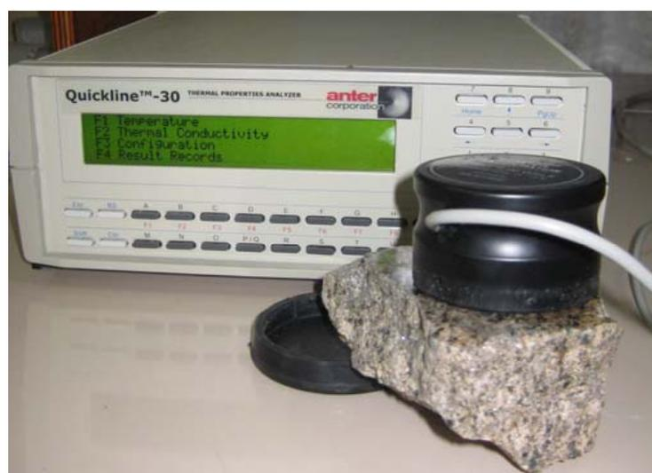
Figura 3.5: Analisador Quickline™-30 na medida de propriedades térmicas.
