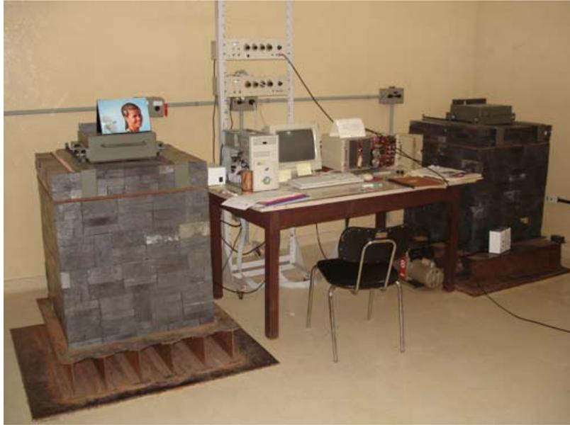
Figura 3.4: Espectrômetros gama localizados no LFNA da UFBA. Castelos, fontes de alimentação dos detectores, sistema conversor analógico digital e computador de controle.
