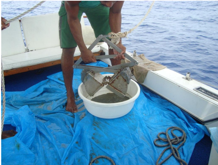
Fig. 2. Draga Van Veen utilizada para a coleta de sedimentos.
