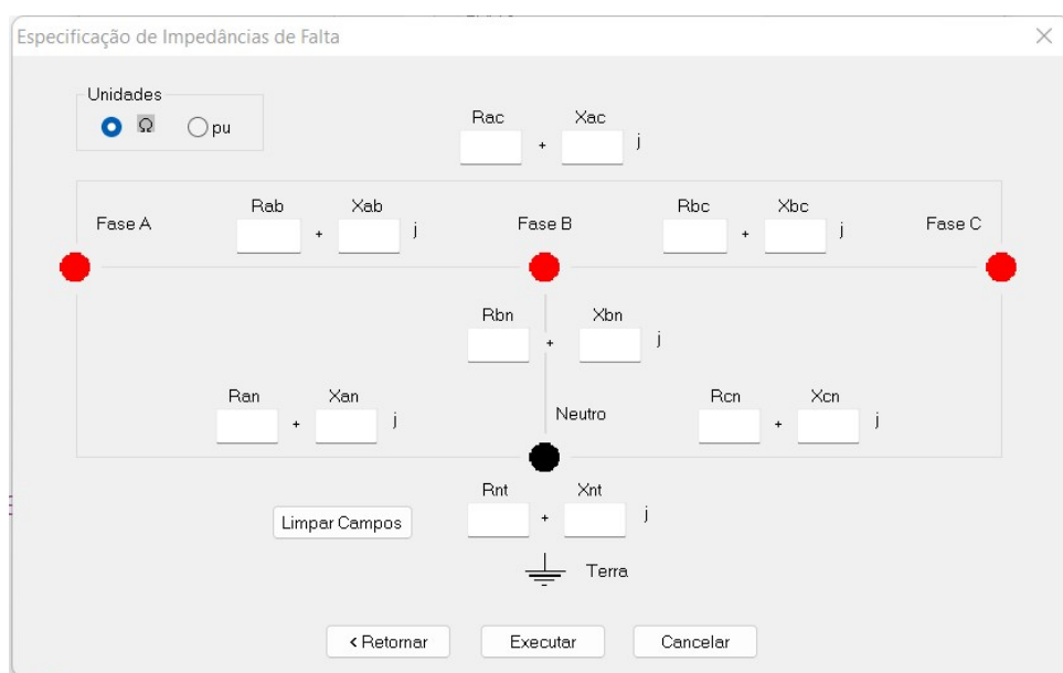
Figura 100 – Especificação de Impedância de Falta
