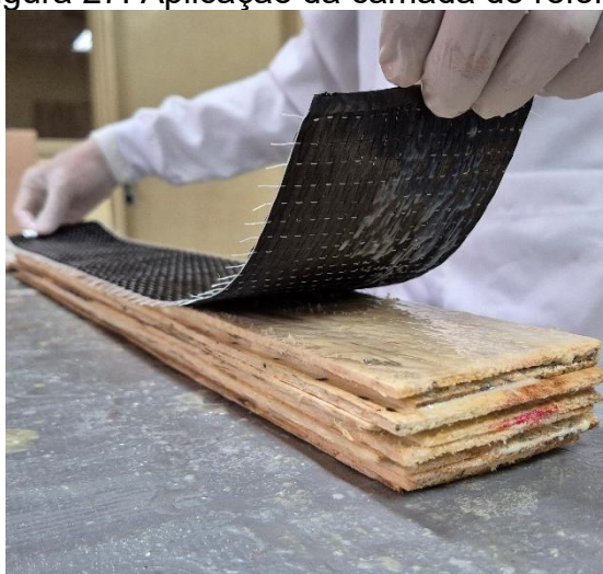
Figura 27. Aplicação da camada de reforço.
