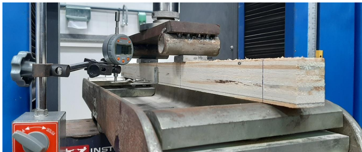
Figura 30. Configuração do ensaio de flexão: (a) realização do ensaio e (b) dimensões do ensaio.
