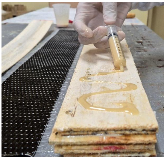
Figura 26. Aplicação do adesivo sobre a superfície da lâmina adjacente ao reforço.
