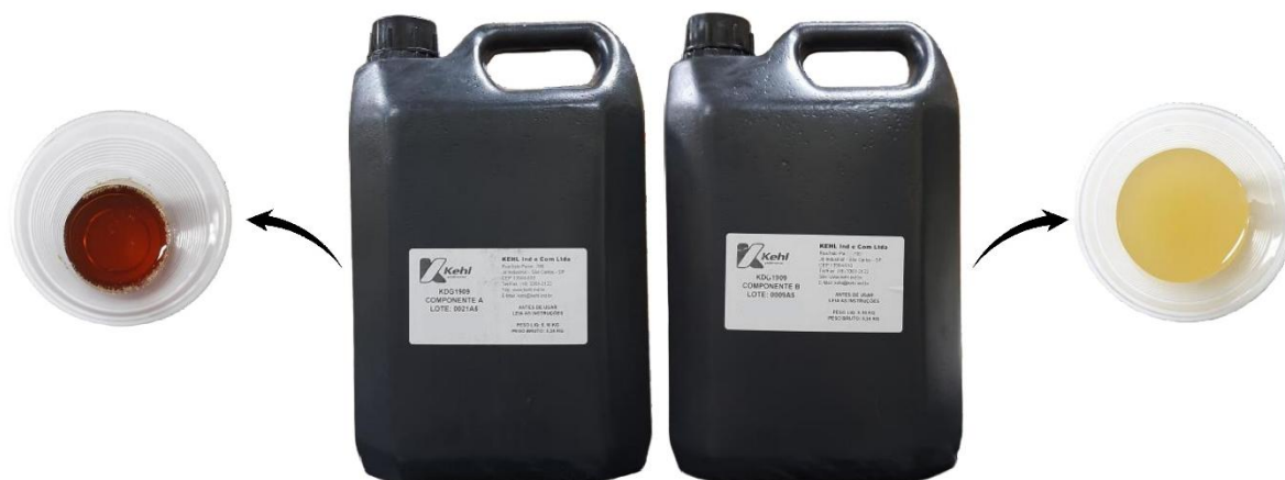
Figura 10. Adesivo poliuretano bicomponente à base de óleo de mamona.
