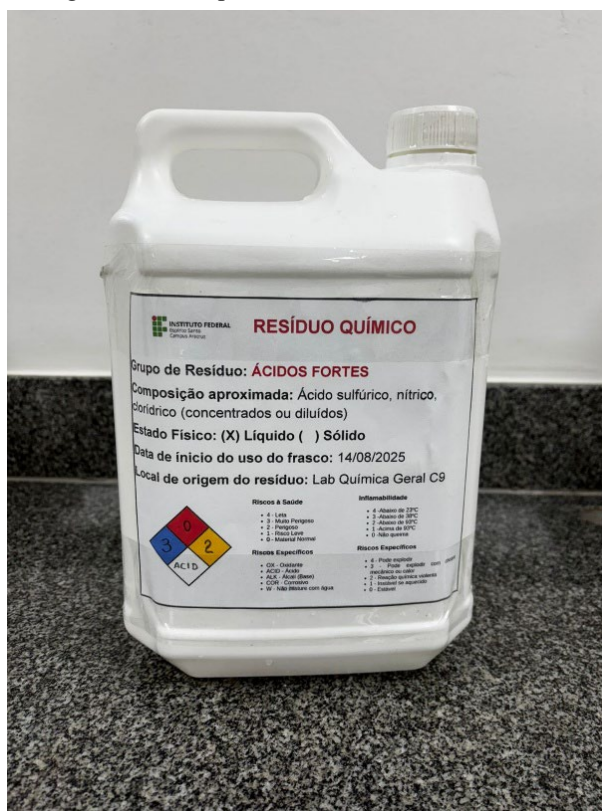
Figura 5 - Exemplo de frasco de resíduo rotulado.
