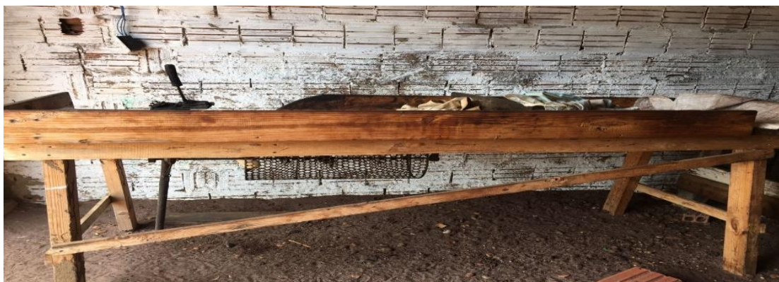
Figura-3 Máquina manual para cortar castanha de caju das trabalhadoras
