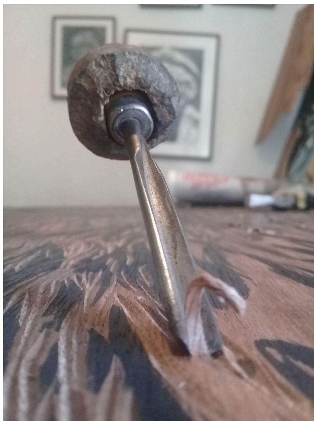
Figura 44 Processos de entalhe. Cabo de goiva improvisado com rolha de camuça. Fonte: do autor
