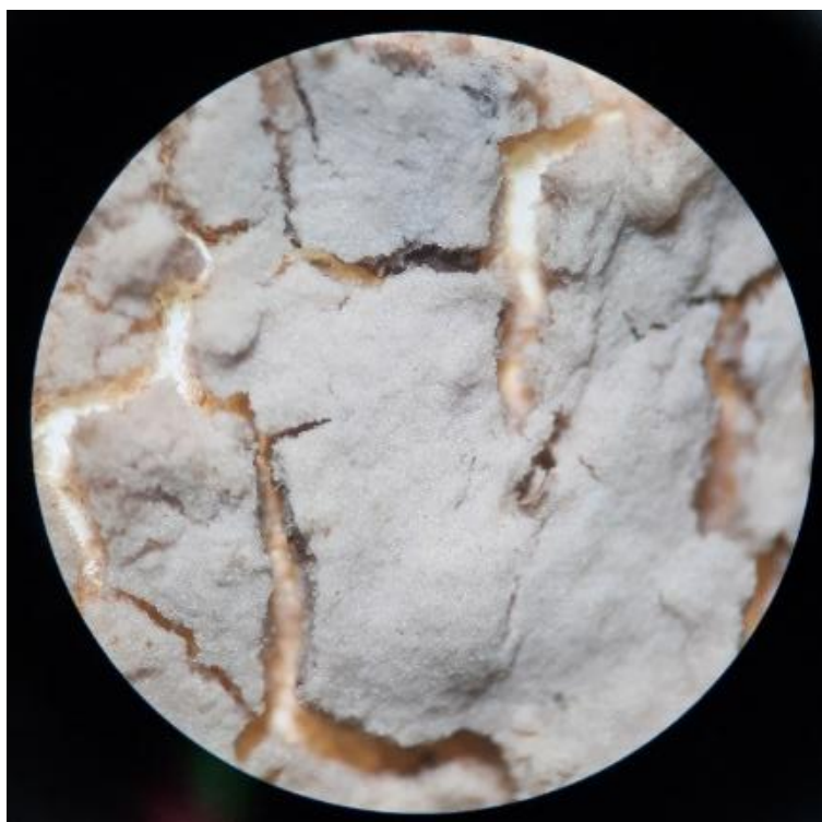
Figura 3 – Filtro de mistura de ésteres de celulose (MCE) 0,45 \mu\text{m} contendo o resíduo sólido da digestão alcalina da infusão de café 6% ( \text{m v}^{-1} ) com emprego de \text{NaClO} sem etapa de separação por densidade.
