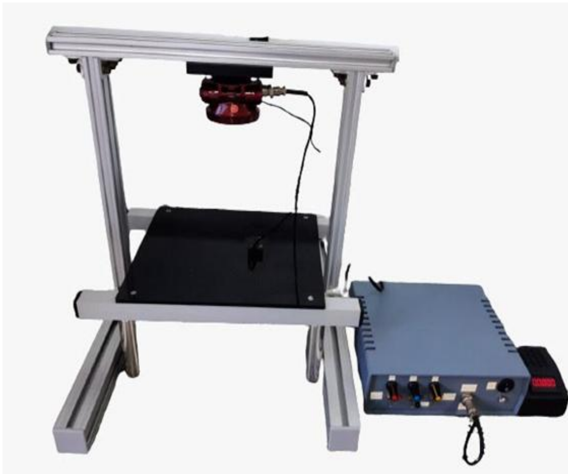
Figura 4.1- Representação esquemática do reator fotoquímico utilizado no processo de fotodegradação dos MPs
