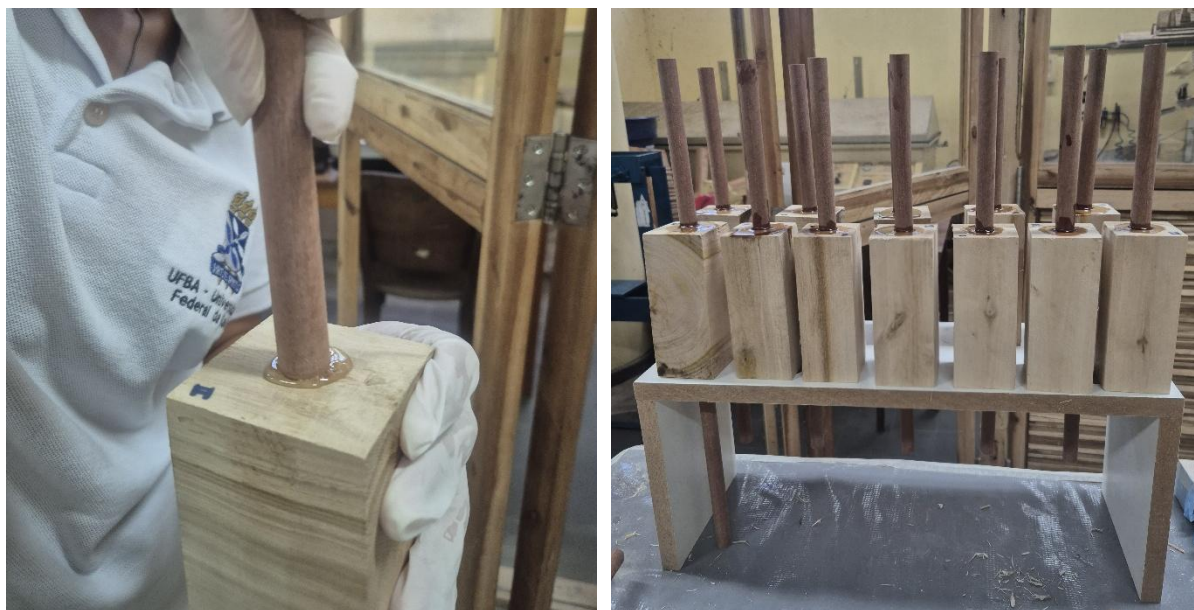
Figura 3.18 – Processo de fabricação dos corpos de prova de arrancamento: inserção da cavilha e cura da resina epóxi.
