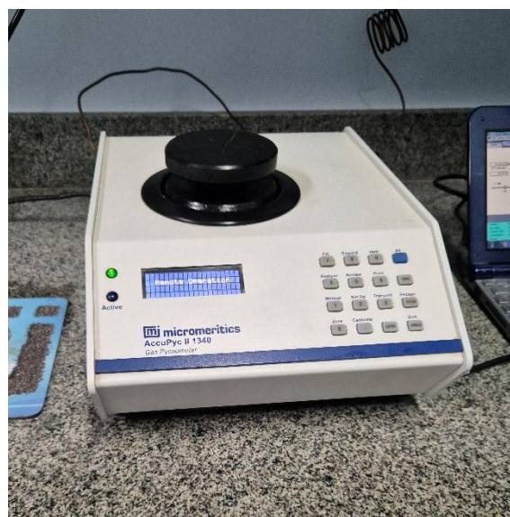
Figura 3.12 – Ensaio de picnometria de gás hélio em fibras de vidro: (a) pesagem da amostra; (b) picnômetro.
