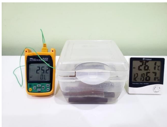
Figura 3.14 – Recipiente de ensaio com controle de umidade da temperatura da água destilada e umidade relativa do ar do ambiente.
