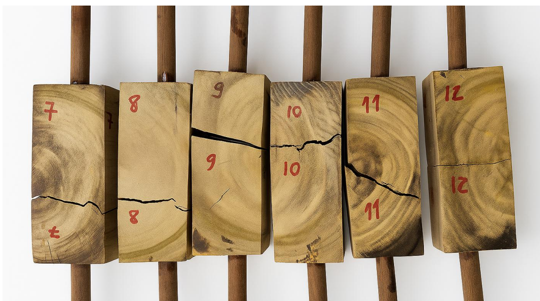
Figura 4.20 – Modo de ruptura tipo B: tração normal às fibras da madeira do bloco.
