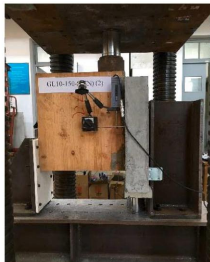
Figura 2.6 – Configuração do push-out test para corpos de prova mistos de madeira e concreto: ensaio de corte único.
