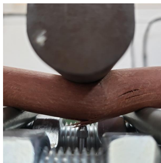
(f) tração e cisalhamento longitudinal.
