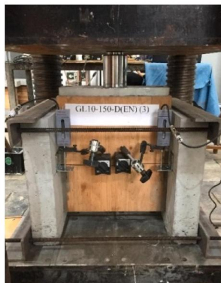
Figura 2.7 – Configuração do push-out test para corpos de prova mistos de madeira e concreto: ensaio de corte duplo.
