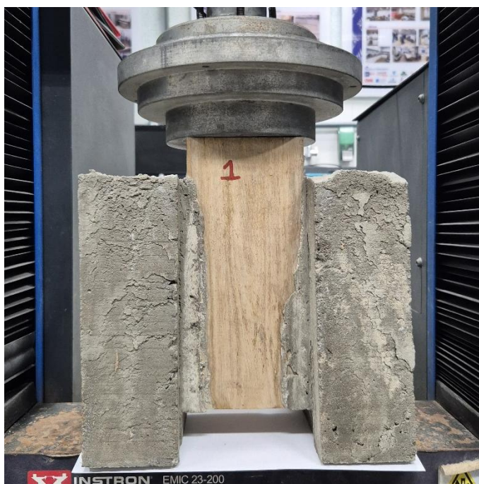
Figura 3.22 – Esquema de ensaio de push-out para corpos de prova mistos de madeira e concreto.
