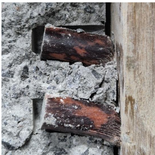
(c) flexão com formação de rótulas plásticas.
