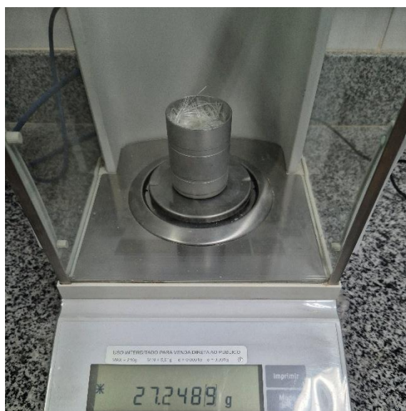
Figura 3.12 – Ensaio de picnometria de gás hélio em fibras de vidro: (a) pesagem da amostra; (b) picnômetro.
