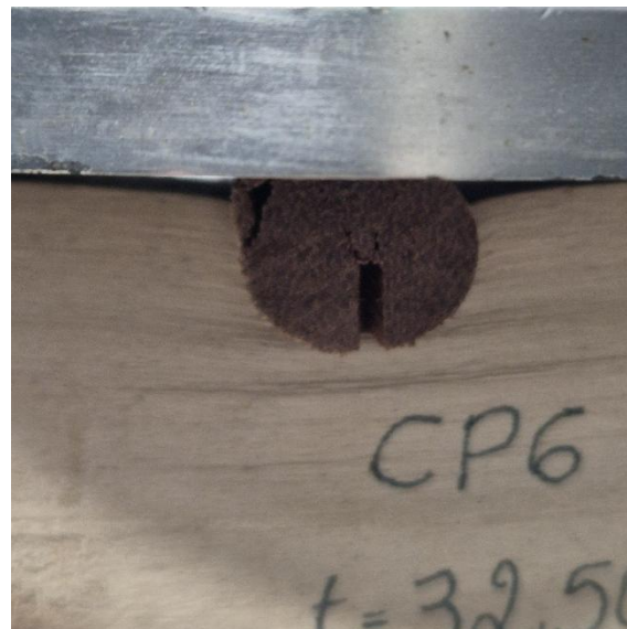
(b) compressão normal às fibras em CP16-90.
