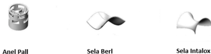
Figura 6 - Selas de Berl e Intalox. Fonte: Adaptado de Bazooyar et al. (2023, p.4).
