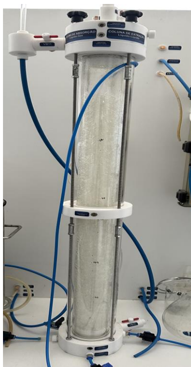
Figura 13 - Coluna absorvedora com anéis de Raschig.
