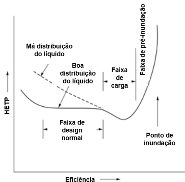
Figura 11 - Perfil de eficiência da HETP para colunas empacotadas. Fonte: Adaptado de Albright et al. (2008, p.1034).
