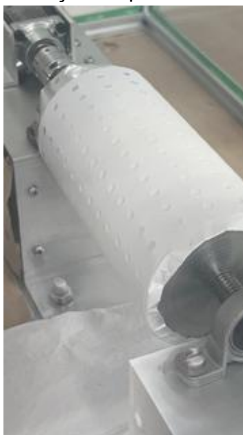
Figura 8 - Fotografia do coletor metálico durante o processo de montagem do NAD usando técnica de eletrofição sequencial.
