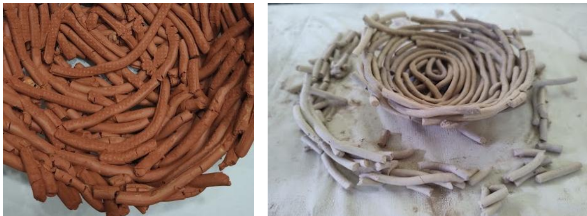
Figura 49 – Rupturas nos fios que compõem o ninho, evidenciadas durante a secagem das peças, e ninho desmantelado devido ao rompimento dos fios e insuficiente sustentação
