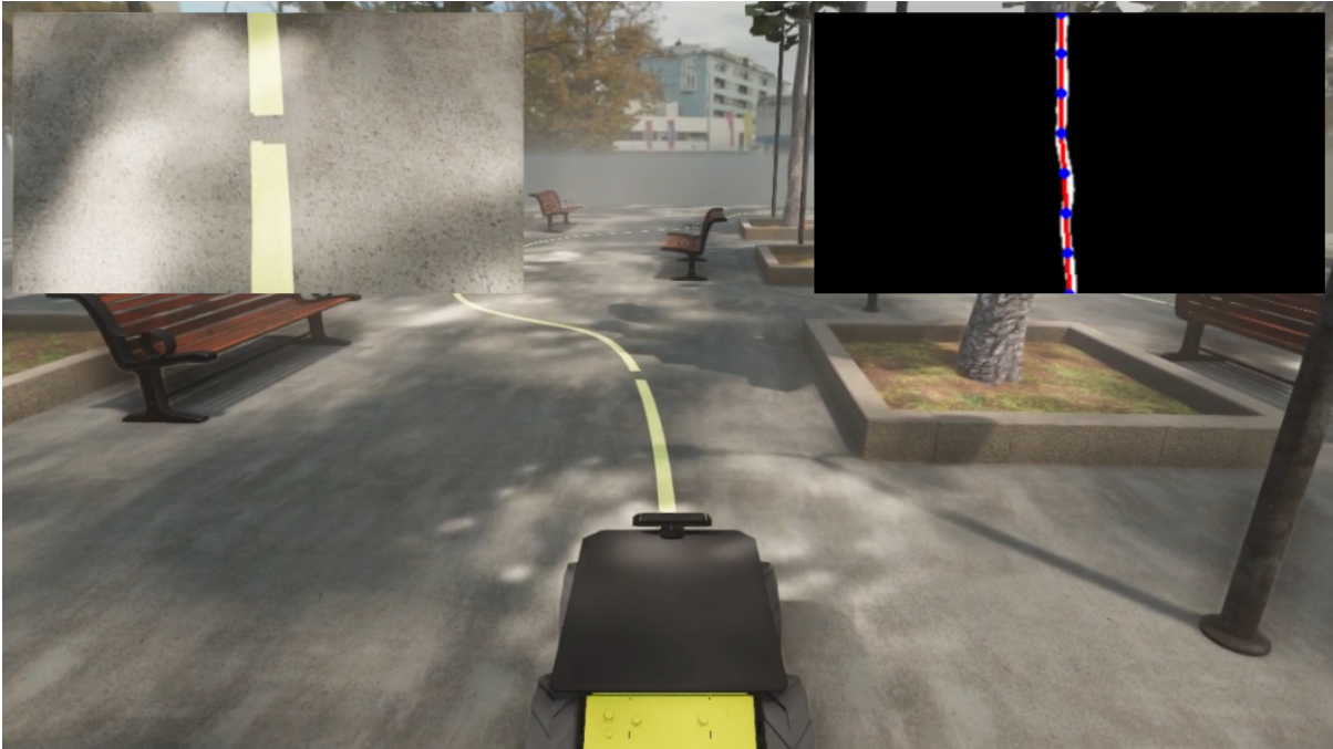
Figura 4.8: Simulação do Husky UGV utilizando a engine Unity. Um video com a demonstração do sistema pode ser visto no link https://youtu.be/V6X5VH_C8pY .
