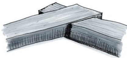
Figura 154 - Croqui da junção das pernas da tesoura a partir de encaixe em sambladura meia madeira
