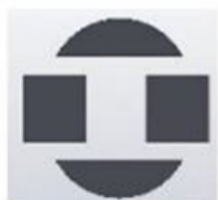
Figura 48 – Corpos de prova para ensaio de resistência à carburização usinados por eletroerosão.
