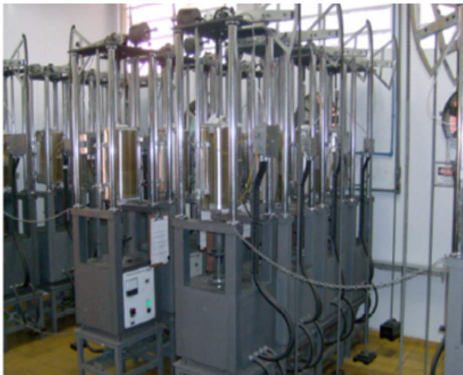
Figura 51 – Aspecto geral das máquinas de ensaio por Fluência utilizadas.
