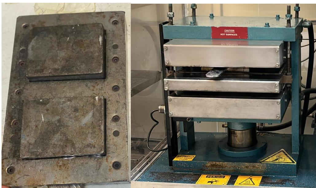
Figura 5 - Molde utilizado para formação dos compósitos à esquerda e o mesmo molde dentro da prensa utilizada.
