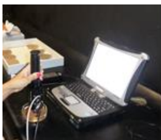
Figura 16 – Análise espectrorradiométrica utilizando o espectrorradiômetro ASD FieldSpec.
