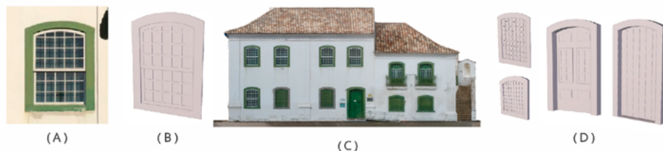
FIGURA 7 – Modelos geométricos das esquadrias e imagens utilizadas como referência, sendo: (a) imagem retificada de uma janela, (b) modelo geométrico feito com base na imagem retificada, (c) ortofoto da fachada principal e (d) modelos feitos com base nas ortofotos
