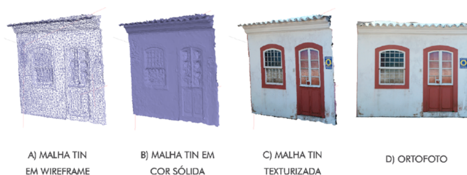
FIGURA 4 – Produtos obtidos no Agisoft PhotoScan após o processamento das fotografias
