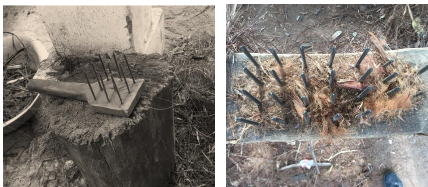
Fig. 158: Escova móvel para limpar a piaçava; fig. 159: Escova fixa para limpar a piaçava. Quilombo de Jatimane, janeiro de 2022 [Fotos: Maria Luedy]
