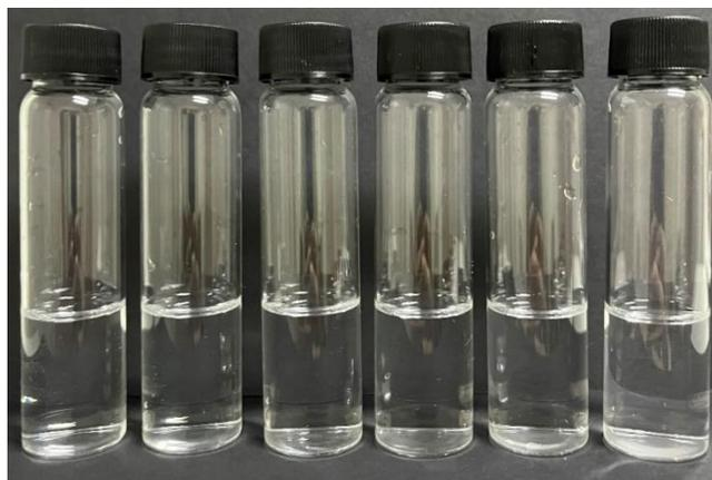
**Figura 26.** Fotografias das soluções binárias SDS-7EO preparadas em concentrações, da esquerda para a direita, iguais a: I) 0,048% v/v em nEO e 0,45% m/v em SDS; II) 0,091% v/v em nEO e 0,42% m/v em SDS; III) 0,17% v/v em nEO e 0,38% m/v em SDS; IV) 0,23% v/v em nEO e 0,35% m/v em SDS; V) 0,33% v/v em nEO e 0,31% m/v em SDS; VI) 0,41% v/v em nEO e 0,27% m/v em SDS.
