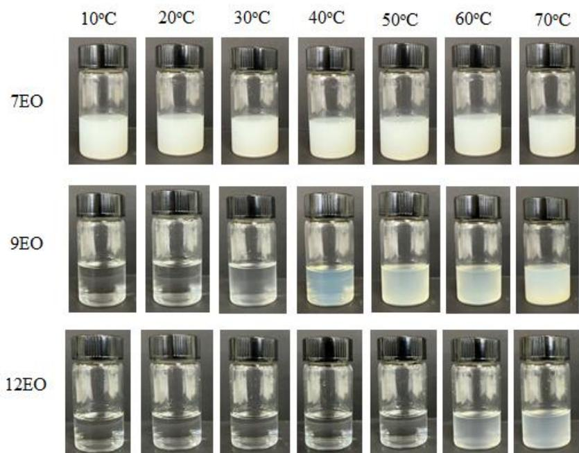
**Figura 23.** Fotografias das soluções ou dispersões aquosas dos surfactantes derivados de cardanol (7EO, 9EO e 12EO) a 2,0% v/v sujeitas a variados graus de aquecimento.
