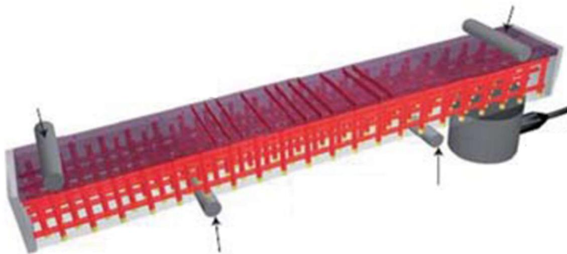
As redes são montadas em áreas propícias à fissuração (DAVIES et al., 2016), no caso de materiais cimentícios, nas áreas flexionadas e cobrimento de aço.
