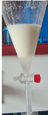
Figura 45. Emulsão Final com microcápsulas de silicato de sódio
