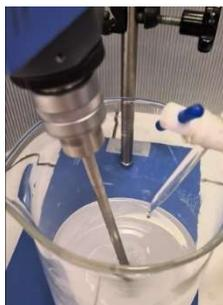
Figura A 15. Pulverização da fase aquosa dentro da oleosa sob agitação
