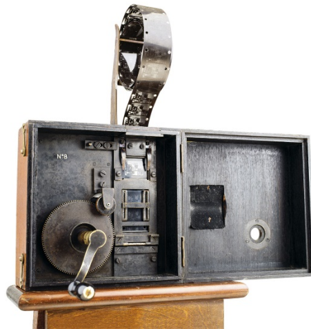
FIGURA 3 – Cinematógrafo inventado pelos irmãos Lumière
