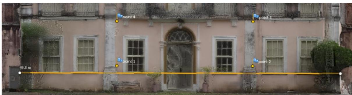
**Figura 10: Medição sobre o modelo em escala desconhecida no Photoscan. Fonte: Elaborado pelos autores.**
