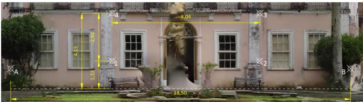
Figura 11: Identificação de coordenadas de referência sobre ortofoto no AutoCAD. Fonte: Elaborado pelos autores.
