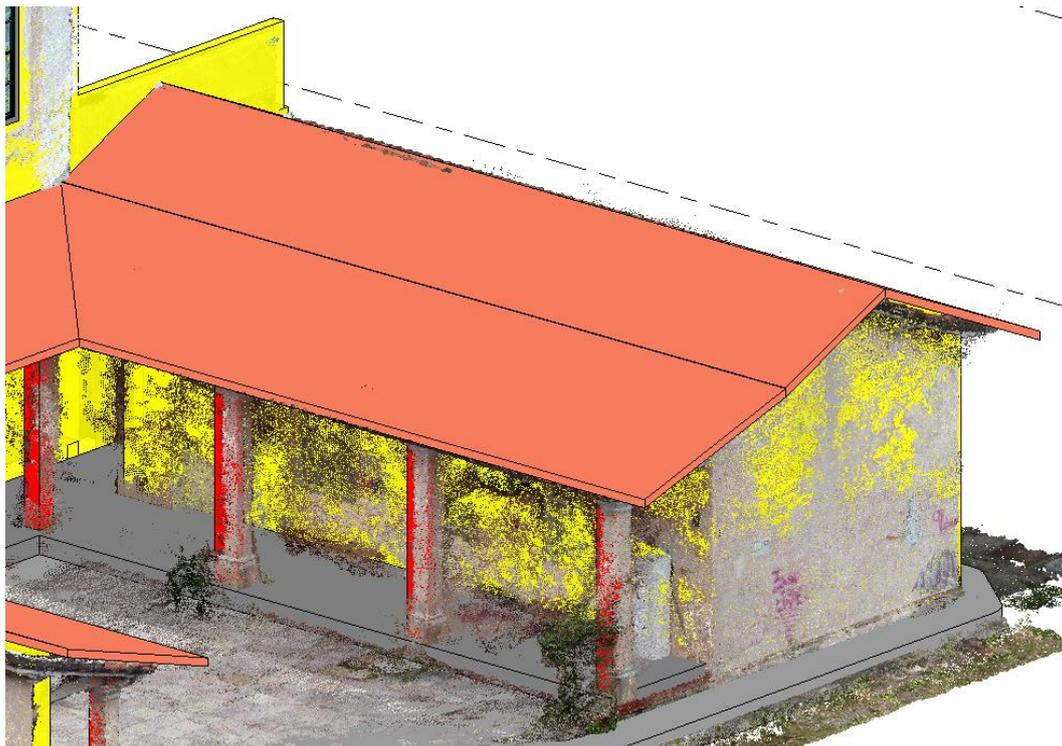
**Figura 20: Sobreposição do modelo BIM com a nuvem de pontos: diferentes inclinações da cobertura. Fonte: Elaborado pelos autores.**
