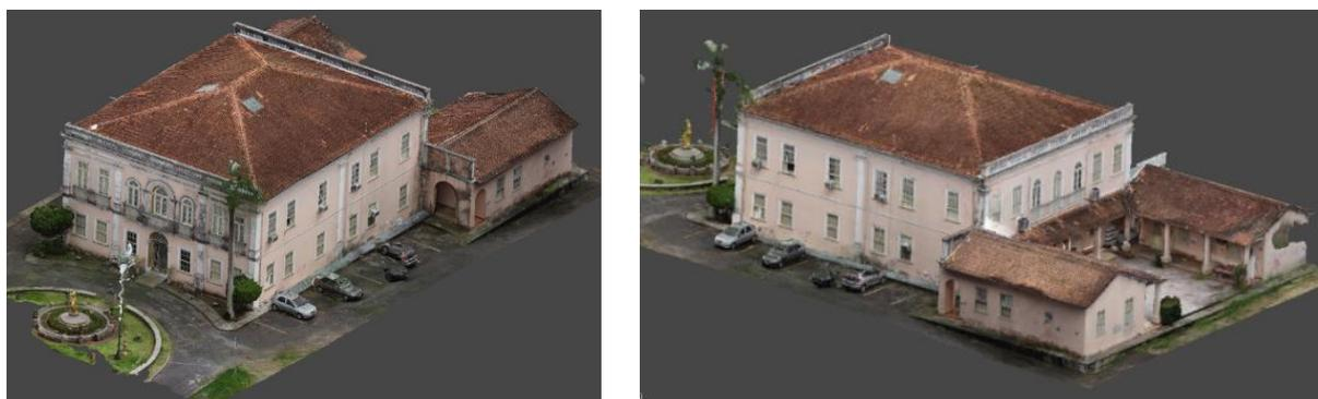
**Figura 9: Malha TIN texturizada do Casarão Rosa (vistas para a fachada principal e posterior, respectivamente). Fonte: Elaborado pelos autores.**
