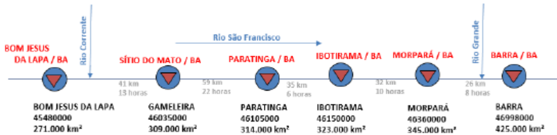
Figura 5 – Diagrama unifilar das estações hidrometeorológicas do trecho baiano do rio São Francisco
